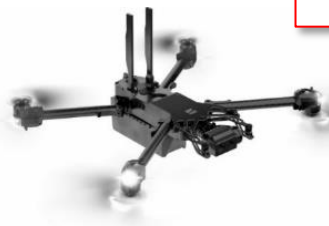
VisualSLAM搭載ドローンで 50cmまで近接
