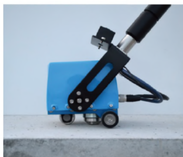
ブルードクター (電磁ハンマー型センサーユニット)
