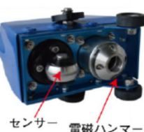
ブルードクター (電磁ハンマー型センサーユニット)
